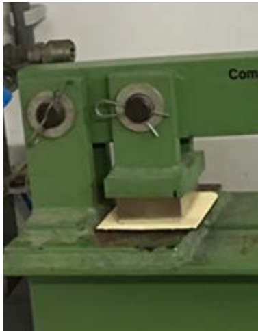
Abbildung 8: Apparatur für Druckprüfung nach SIA 280:1996.
