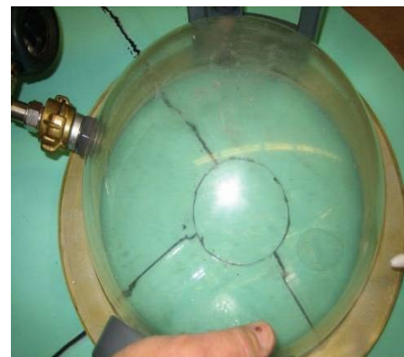
Abbildung 15: Qualitätskontrolle der Schweissnähte. Bei linearen Übergängen der Abdichtungsbahn (links) wird das Volumen zwischen der doppelten Schweissnaht unter Druck gesetzt und auf Entweichen kontrolliert. An einem T-Stoss (rechts) wird die Integrität der Schweissnähte mit einer Vakuumglocke sichergestellt.
