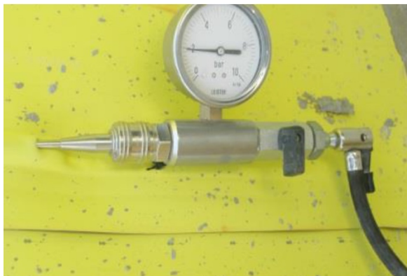
Abbildung 15: Qualitätskontrolle der Schweissnähte. Bei linearen Übergängen der Abdichtungsbahn (links) wird das Volumen zwischen der doppelten Schweissnaht unter Druck gesetzt und auf Entweichen kontrolliert. An einem T-Stoss (rechts) wird die Integrität der Schweissnähte mit einer Vakuumglocke sichergestellt.
