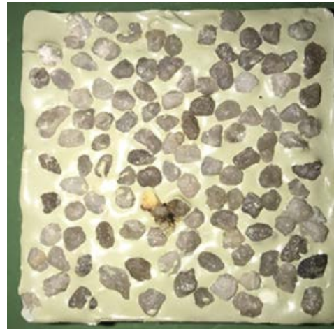
Abbildung 9: Normdruckkörper nach SIA 280:1996 (50 mm x 50 mm; 3 mm gebrochene Quarzkörner).
