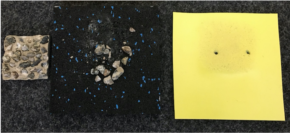
Abbildung 11: Zustand der Abdichtungsbahn und der Schutzschicht nach dem Druckversuch bei 40°C und 100 bar auf eine 0-8mm Körnung.
