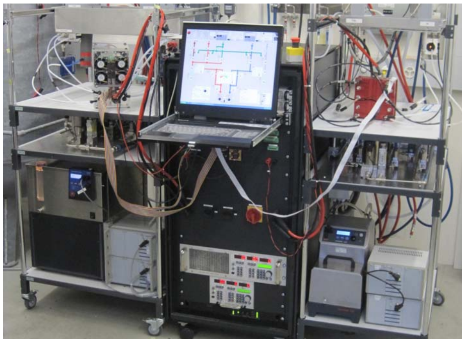
Figur 1: Teststand für 10W e – 1 kW e mit Gassystem (l 100W-1kW; r 10W-100W), Elektrickrack (m)
