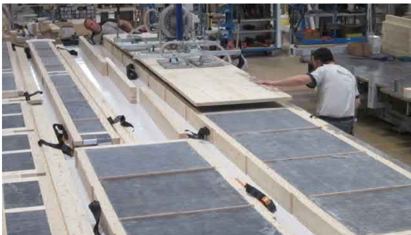
Abbildung 19: Kastenelement im Sandwichsystem
