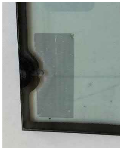
Abbildung 4: Vakuumbglas mit stirnseitigem Ventil
