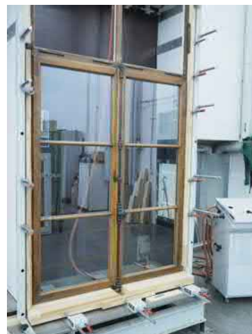
Abbildung 14: historischer Rahmen auf dem Prüfstand
