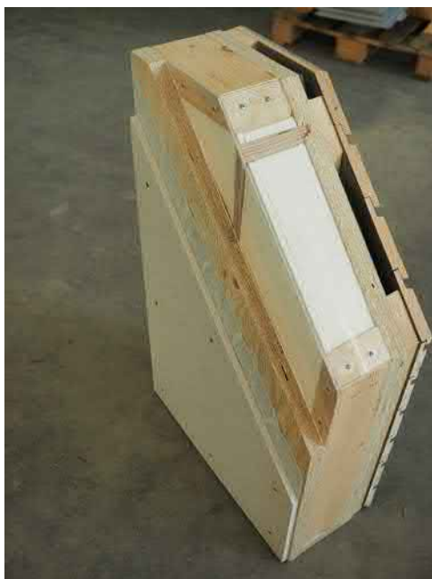
Abbildungen 72: 73, 74, 75, und 76: Aufbau klassisches Wandelement mit Steinwolle Dämmung im Vergleich mit Aerogel-Spaceloft Dämmung, Aerogel Pureflex und Isopet Dämmung.
