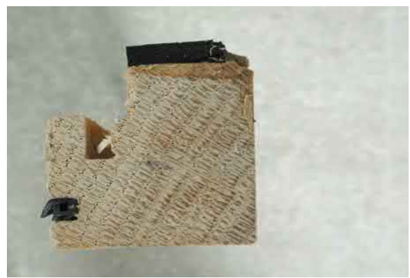
Abbildung 10: Querschnitt Abdeckleiste mit Dichtungsschnur und Silikonfuge
