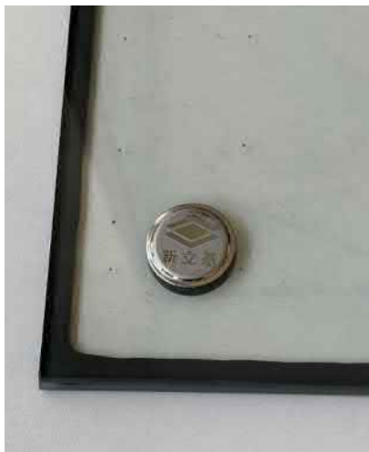
Abbildung 3: Vakuumbglas mit rundem «Ventil»
