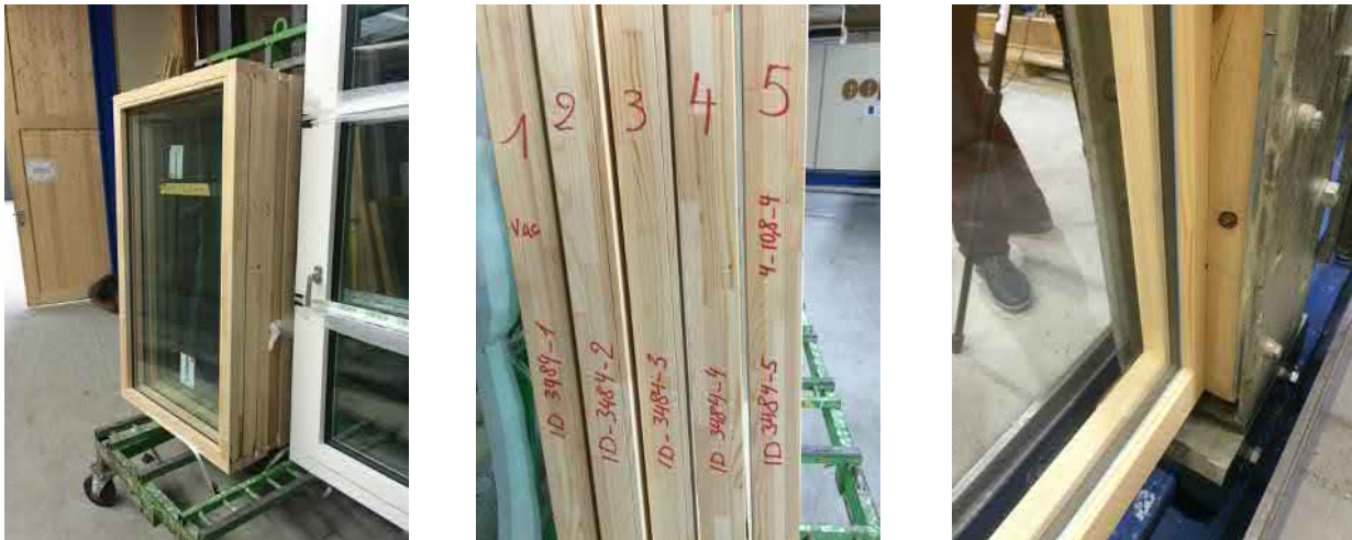
Bild 4. Fünf in Holzrahmen eingebaute Gläser davon 3 Vakuumgläser und 2 konventionelle 2-fach Isoliergläser. Probengrösse 760 mm x 1409 mm Glasgrösse
