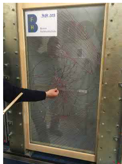
Abbildung 45: Bruch des Vakuumglases 3484-3 bei c = 200
