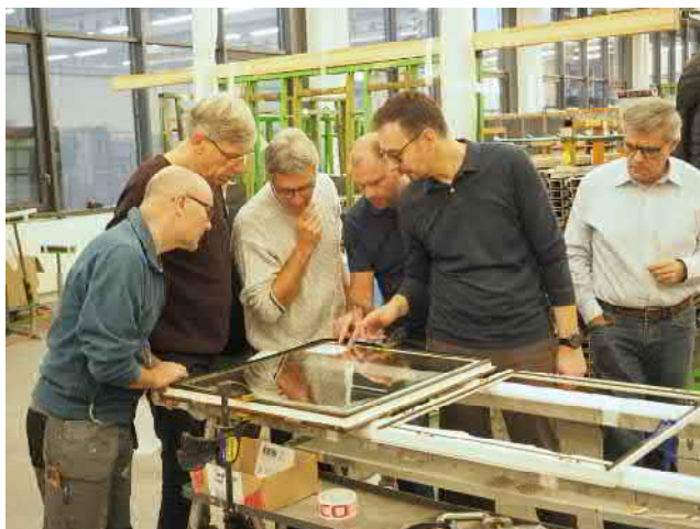
Abbildung 13: historischer Rahmen mit Vakuumglas saniert
