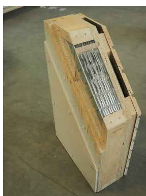
Abbildungen 72: 73, 74, 75, und 76: Aufbau klassisches Wandelement mit Steinwolle Dämmung im Vergleich mit Aerogel-Spaceloft Dämmung, Aerogel Pureflex und Isopet Dämmung.
