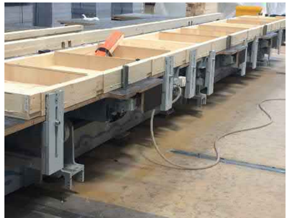
Abbildung 21: Kastenelement bereit zur Dämmung
