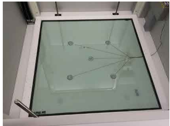
Bild 1. Einbau eines Vakuumglases mit Thermoelement-Folie und Kontaktpaste
