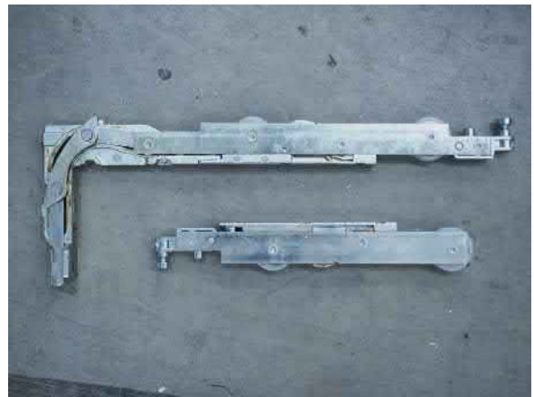
Abbildung 16: miniaturisierte Beschläge im Test
