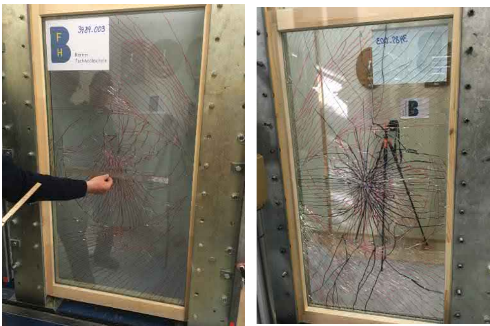
Bild 5. Bruch des Vakuumglases 3484-3 bei c = 200 (Bild 3), Schwarz: Bruchlinien auf dem vorderen Glas (Aufprall) Rot: Bruchlinien im hinteren Glas
