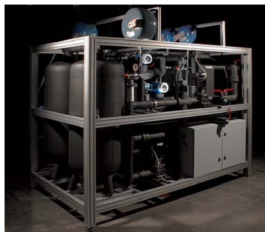
Abb. 5-3: Luftaufbereitungsanlage mit L/W-WP-Prototyp (links) und Wärmemodul (rechts) im Labor der HSLU
