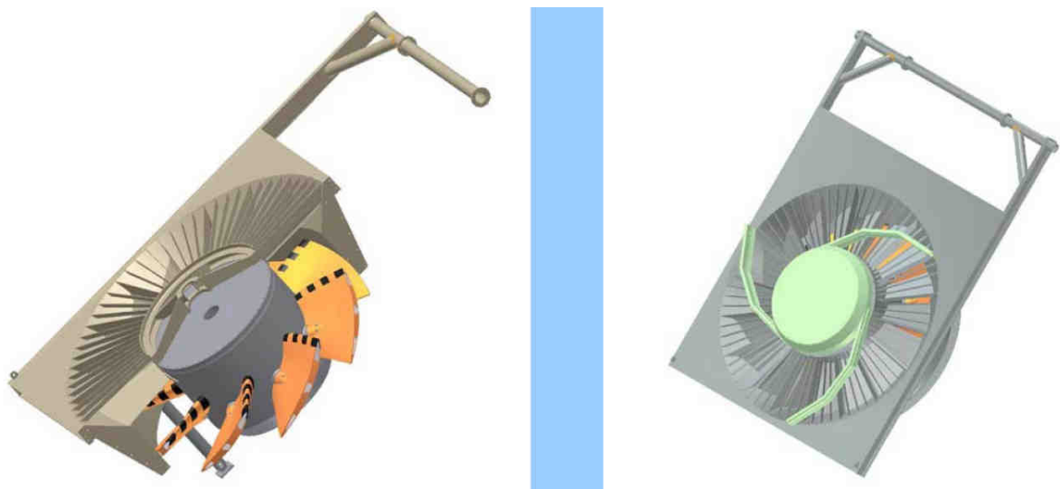
Fig. 29: Schnittbild und Ansicht (mit rotierendem Rechenreiniger) der VLH Turbine (Quelle: Stellba Hydro)
