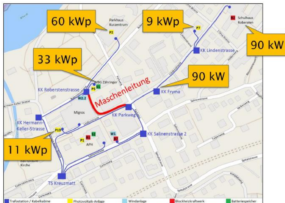
Abbildung 17: Übersicht über die Vermaschung des NS-Netzes, d.h. des geschlossenen Ringes mit abgehenden Stichleitungen
