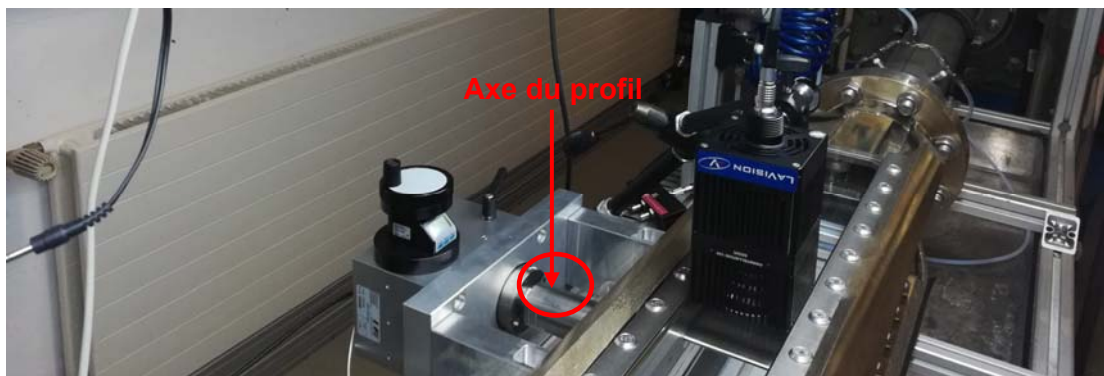
Figure 20 Emplacement des coups de marteau sur l'axe du profil NACA.
