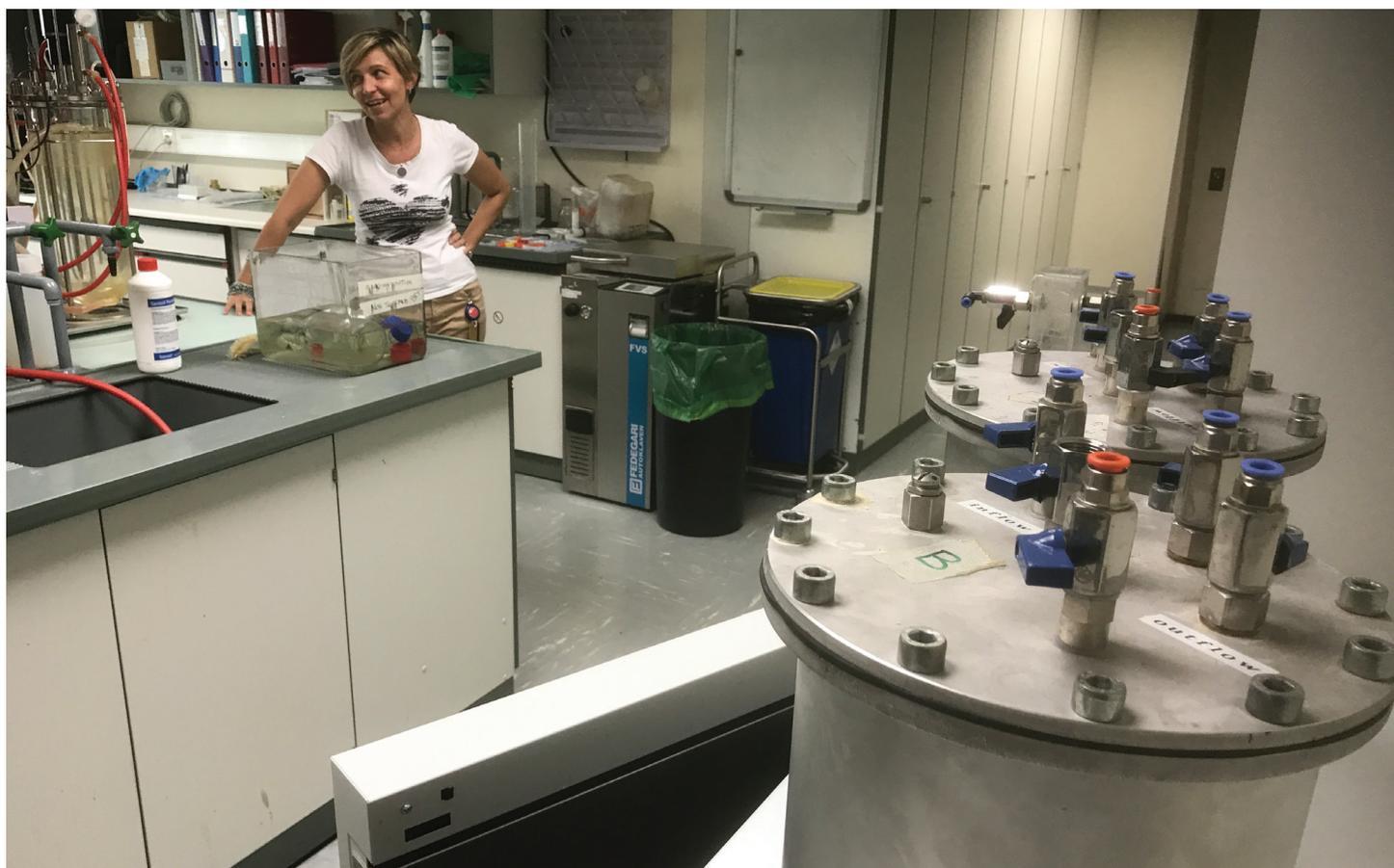
Blick ins SUPSI-Labor in Manno (TI): Ein Forscherteam um Dr. Pamela Principi (im Bild) hat hier ein zweistufiges, anaerobes Gärverfahren für Industrieabfälle untersucht. Rechts sind die beiden Reaktoren für die zweistufigen Gärversuche zu sehen. Foto: B. Vogel
