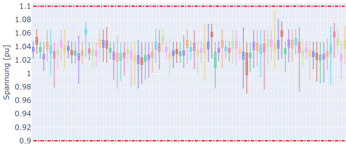
Abbildung 11: Spannungen pro TS-Kreis (MV-Ebene: erste drei Box-Plots) im Basisjahr 2017
