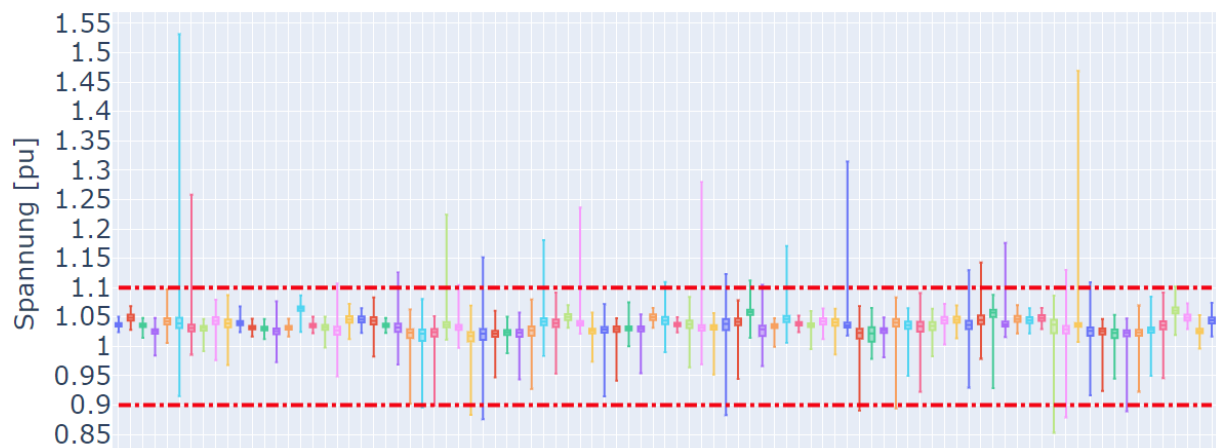
Abbildung 50: Spannung [pu] pro TS-Kreise (mit MV-Ebene) für Nep.2050 ohne SmartGrid-Einsatz.
