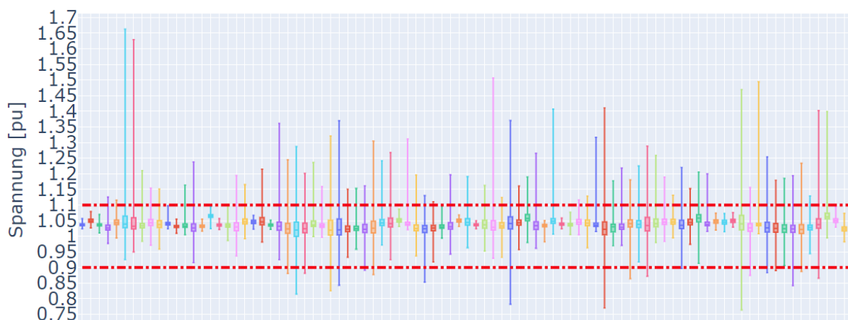
Abbildung 59: Spannung [pu] pro TS-Kreise (mit MV-Ebene) für Utopia.2050 ohne SmartGrid-Einsatz.
