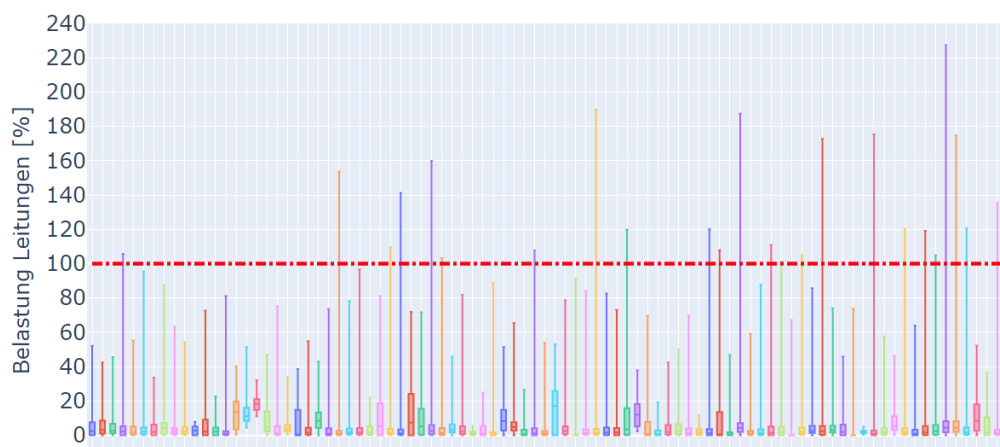
Abbildung 23: Belastungen der Leitungen [%] pro TS-Kreis (MV-Ebene: erste drei Box-Plots) im Basisjahr 2017 für die Top-Down-Modellierung
