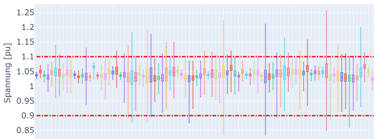
Abbildung 62: Spannung [pu] pro TS-Kreise (mit MV-Ebene) für Utopia.2050.smart (mit SmartGrid-Massnahmen).
