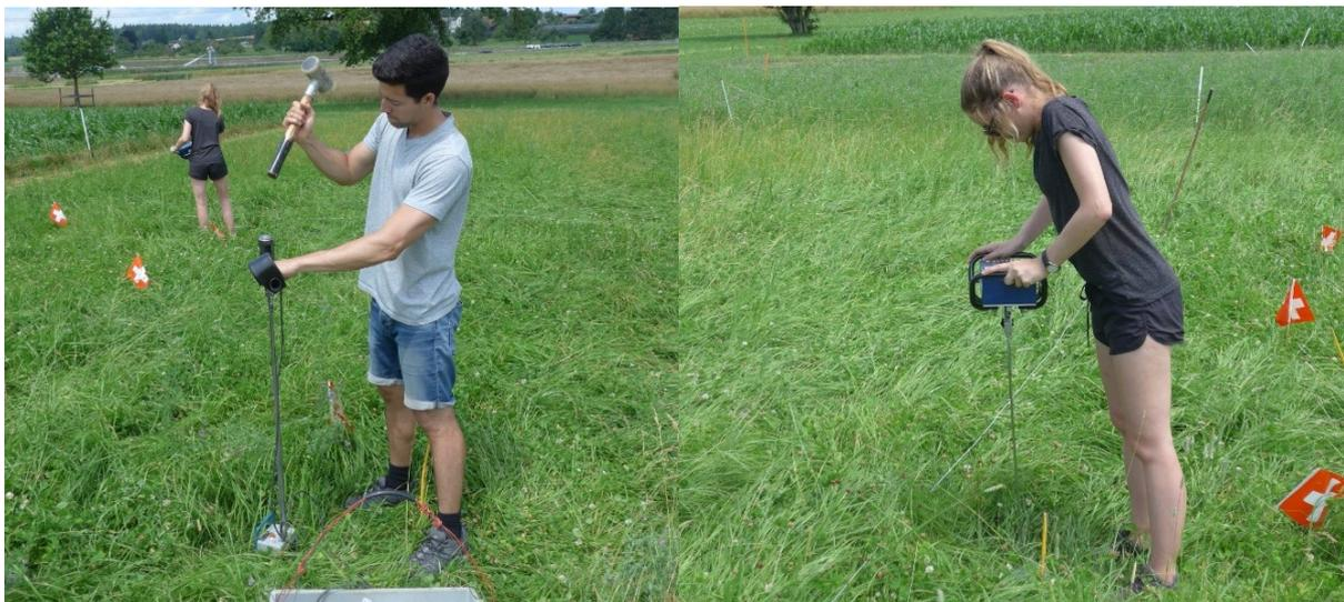
Abb. 1: **Links:** Messung mit PANDA-Sonde von Sol Solution. **Rechts:** Messung mit Penetrologger von Eijkelkamp (Fotos P. Schwab, 2019).
