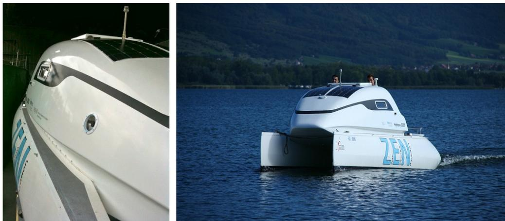
Figure 8 : En 2011, des panneaux solaires ainsi qu'une trappe de remplissage externe d'hydrogène ont été ajoutés
