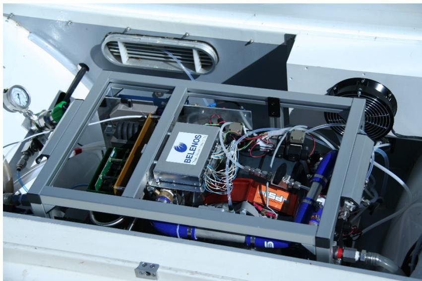
Figure 10 : Pile à combustible oxygène pur/hydrogène de Belenos
