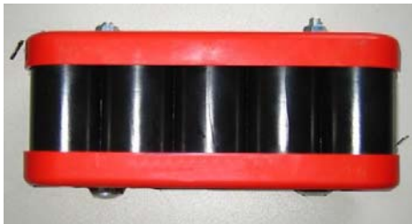
Bild 14: NiCd Rundzellen zu einem Block geformt
