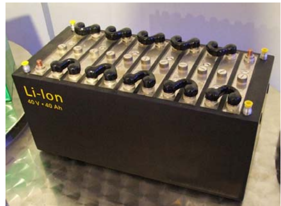
Bild 21: Li-Ionen Akkumulatoren, wie sie in Hybrid- und Elektrofahrzeugen eingesetzt werden, Quelle: [7]
