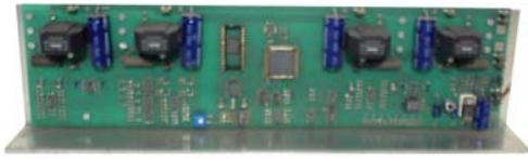
Bild 19: Strangladegerät für NiMh Akkumulatoren für den Einbau in Fahrzeuge
