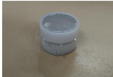
4: Fertiger Probenbecher für Messung in Probenkammer
