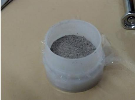
1: Probenbecher mit Mylar Film und Probematerial
