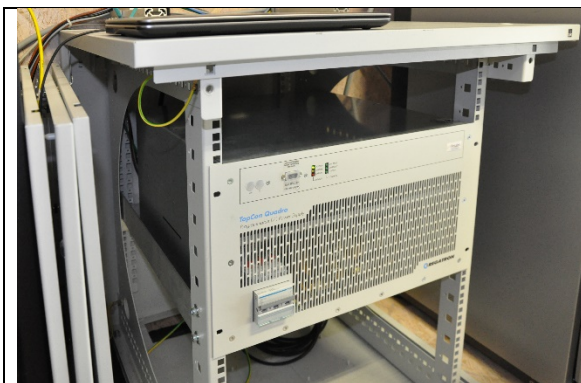
Abb. 28: PV-Emulator unten mit Modul-Kennlinien-Ansteuerungssoftware (Regatron Topcon Quadro)
