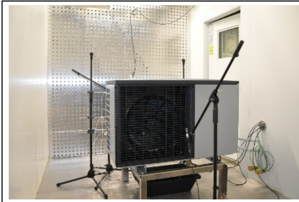
Abb. 26: Wärmepumpen-Ausseneinheit instrumentiert in der Klimakammer
