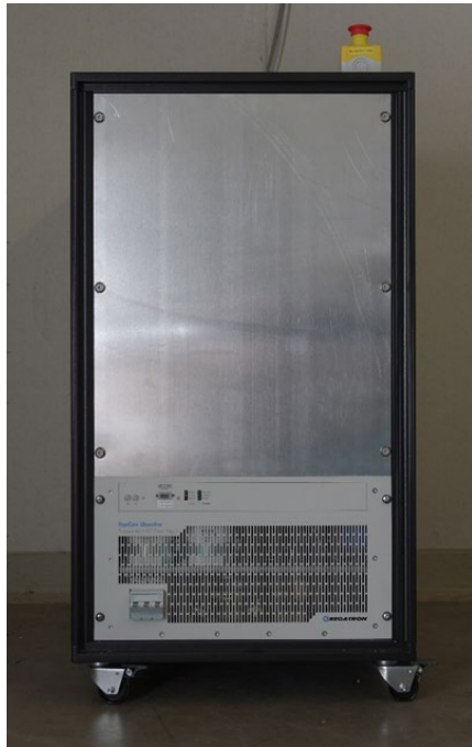
Abbildung 2: Gleichstromquelle zur Emulation der PV-Module.
