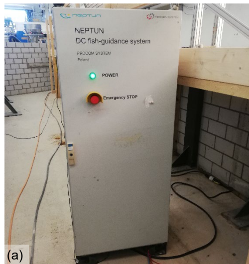
Abbildung 5: (a) Steuerschrank des NEPTUN-System der Firma Procom und (b) Schema des gepulsten Gleichstroms
