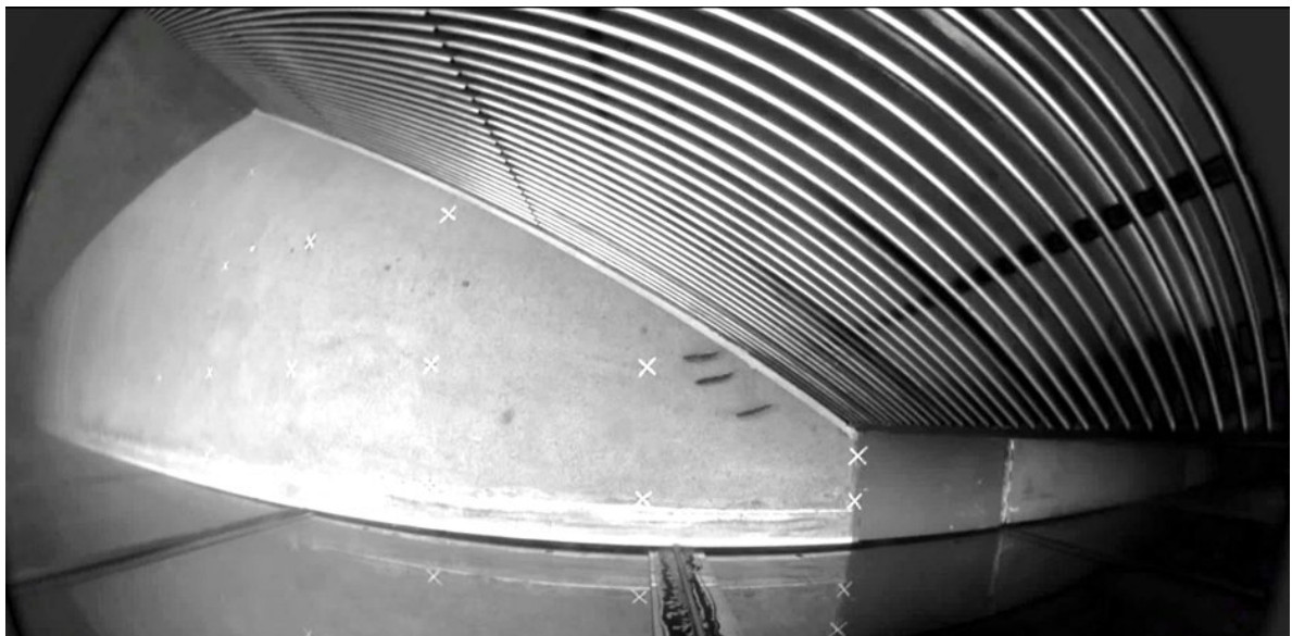
Abbildung 3: Standbild aus Unterwasser-Videoaufnahme, Versuch mit Horizontalrechen, drei Schneider nähern sich dem Bypass (rechts)
