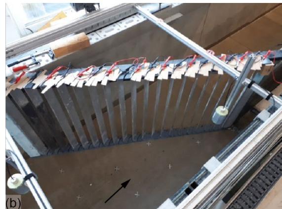
Abbildung 6: Elektrifizierung des Vertikalrechens mit einem lichten Stababstand von (a) s_b = 50 mm und (b) s_b = 110 mm
