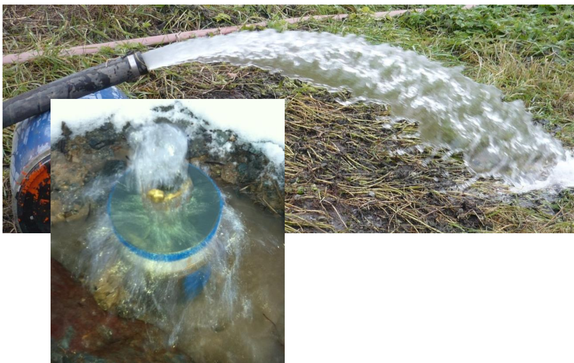
Figure 8 : Forage CHA-1 jaillissant et pompage durant 18 heures réalisé en novembre 2014.
