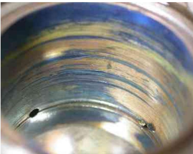
Fig. 31: Lagerbuchse nach 300 Stunden
