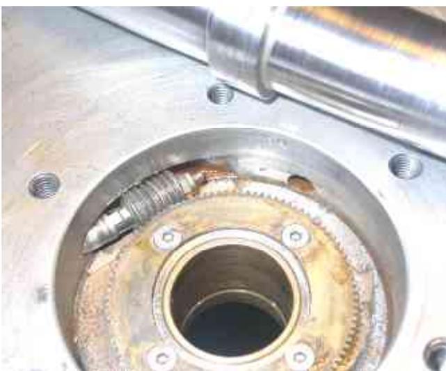
Fig. 29: Lagerbuchse und Welle nach 50 Stunden
