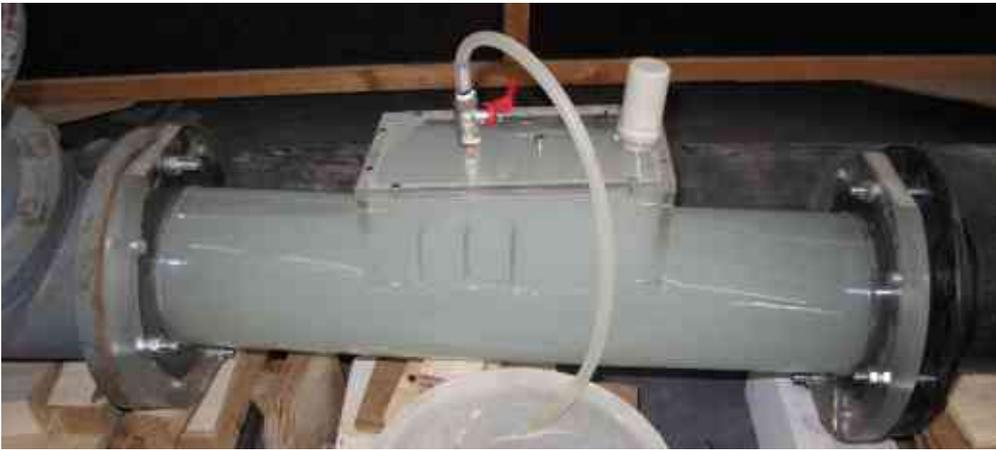
*Fig. 17: Abscheidkammer nach zweitem Absperrschieber*
