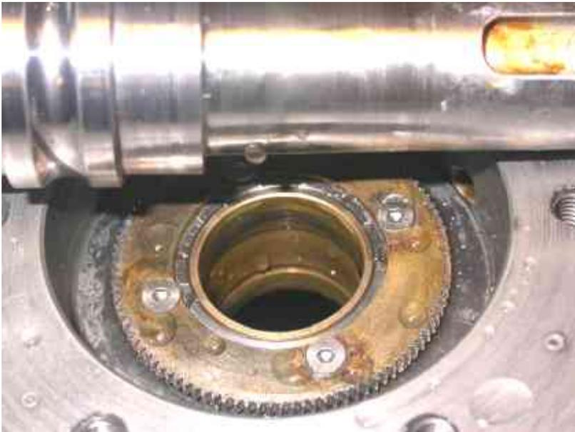
Fig. 28: Lagerbuchse und Welle nach dem Einlaufen
