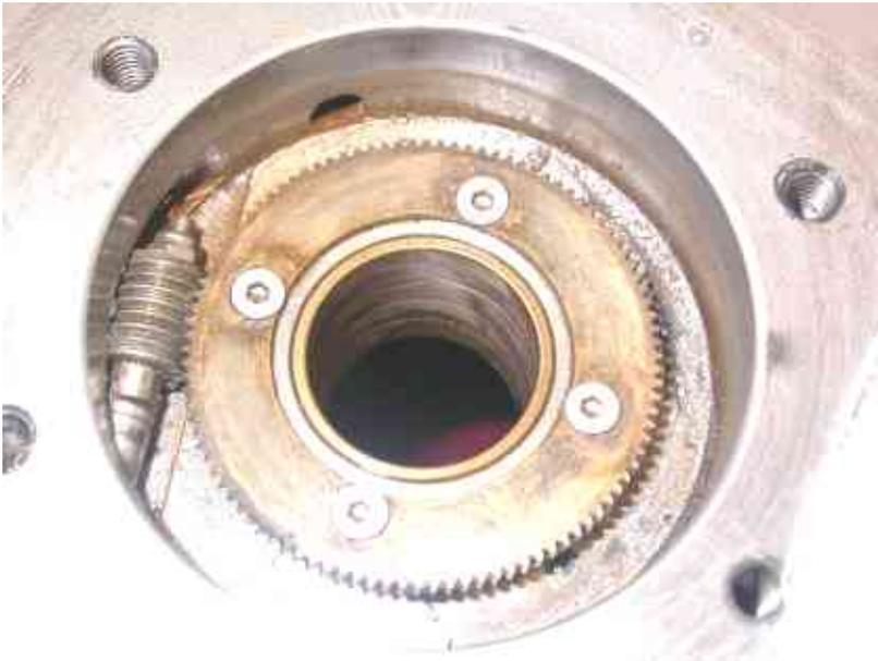
Fig. 30: Lagerbuchse nach 150 Stunden
