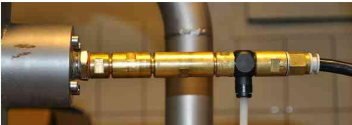
*Fig. 19: Wasserstrahl-Gasverdichter an der Modellturbine*
