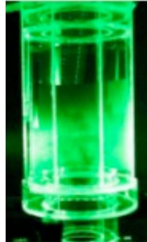
Bild 2 Skaliertes Plexiglasmodell der Brennkammer für experimentelle Strömungsuntersuchungen im Labor.
