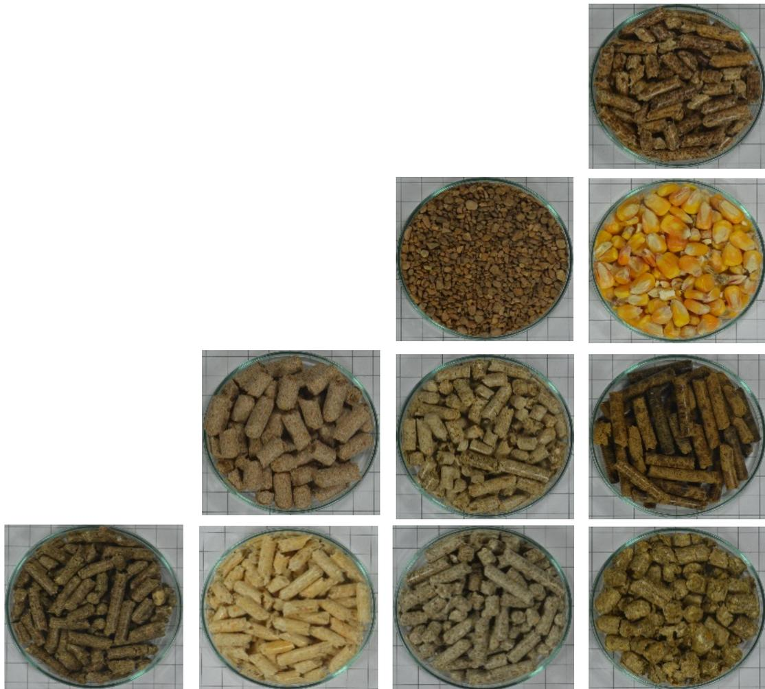
Bild 6 Brennstoffe für Verbrennungsversuche in 35 kW-Prototyp: Fichtenpellets (ISO A1), Getreidemühlen-Rückstände, Virginia-Malve, Weide (SRC), Bambus, Getreideschalen, Miscanthus, Heu und Weinbergsbeschneidung, Mais (Mykotoxin-kontaminiert, Oliven-Steinschrot [7].
