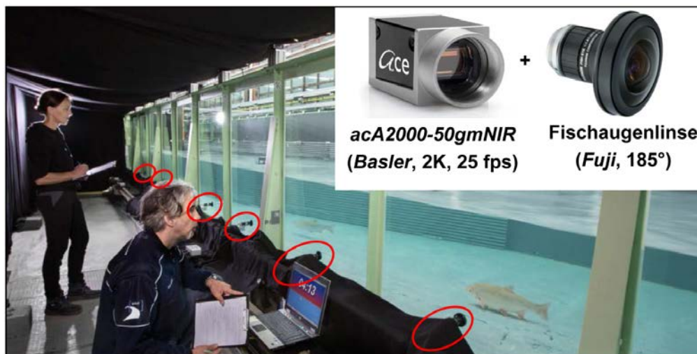
Abbildung 2: 3D Fishtracking System mit mehreren synchrongeschalteten Kameras (Quelle: BAW)
