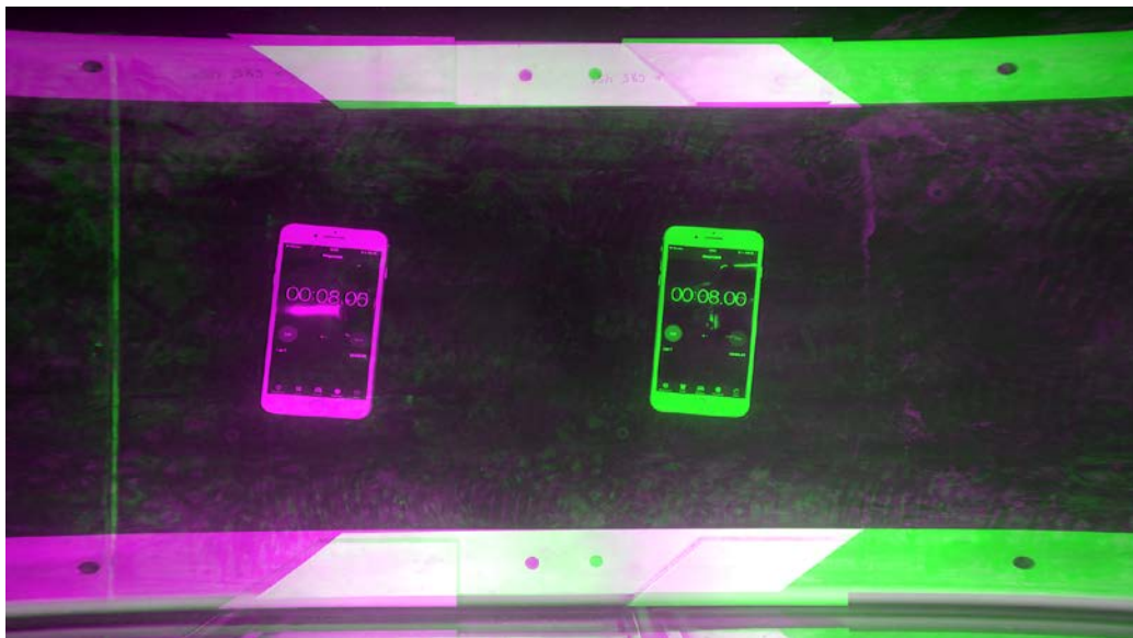
Abbildung 4: Verzerrte und überlagerte Aufnahmen der Kameras nach Synchronisierung: Beide Kameras zeigen eine Zeit von 8.05–8.06 s (grün: Kamera 1, violett: Kamera 2).
