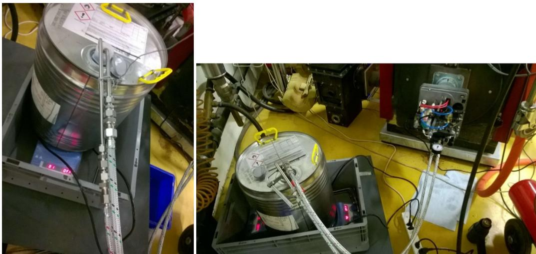
Abbildung 2: Brennstoffversorgung mit Waage und Heizplatte
