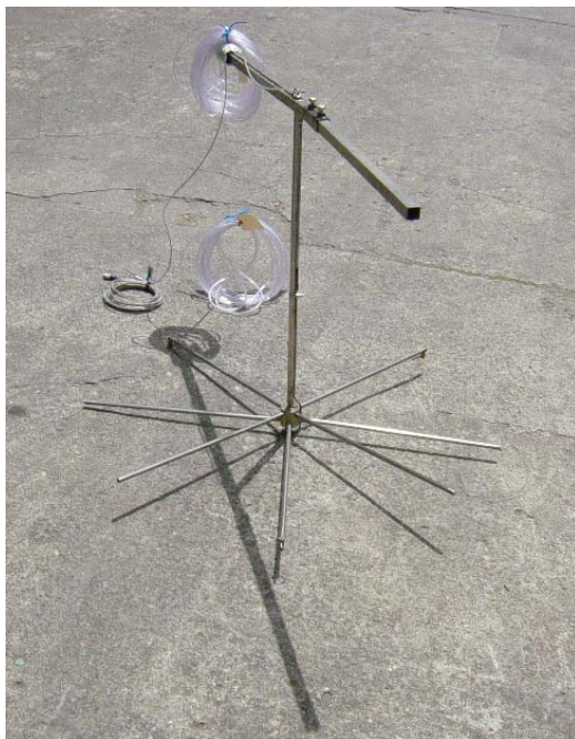
Abbildung 13: Messkreuz zur Staudruckmessung im Kamin
