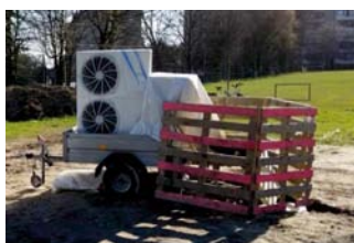
1 PAC Air-eau et 1 Mini-Module pour TRT froid
