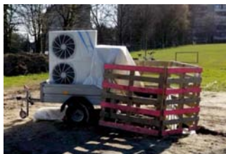
1 PAC Air-eau et 1 Mini-Module pour TRT froid
