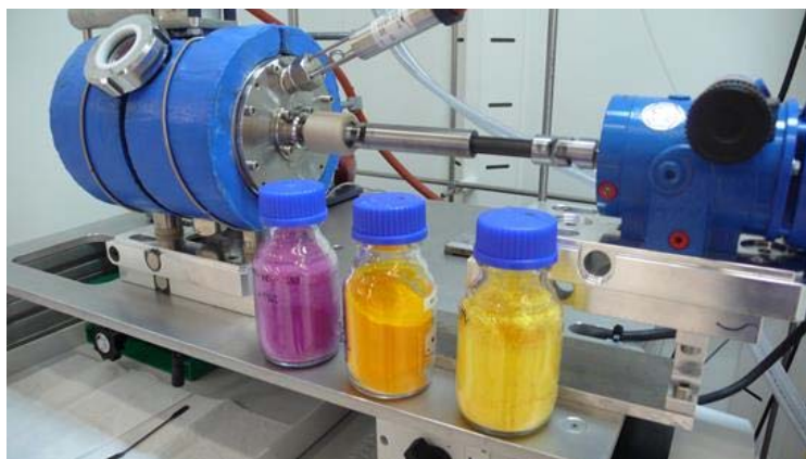
Figur 4: Interkalator für die Herstellung von 100 Gramm-Mengen an ZeoFRET®. Drei Produkte von Testsynthesen (100 g Massstab) sind im Vordergrund gezeigt.
