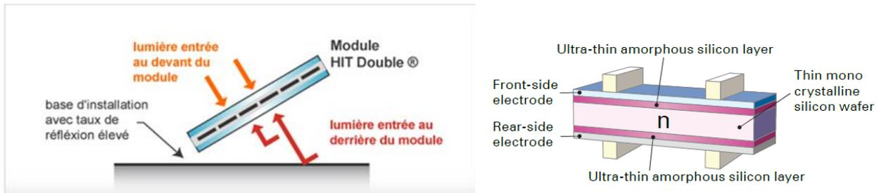
Figure 8: Illustration des caractéristiques du module HIT
