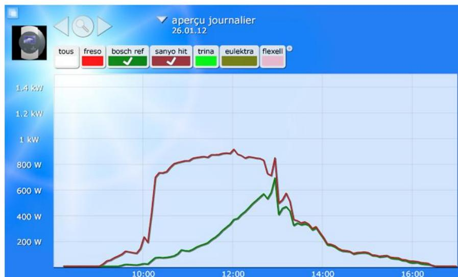
Figure 9: Profil de production du 26 janvier 2012 de l'installation Sanyo (courbe marron) et de l'installation de référence (vert)
