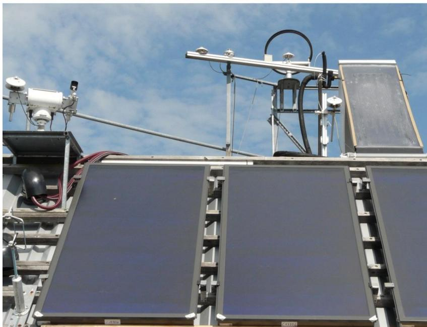
Abbildung 7: Foto der Kollektoren mit Harfen-Absorberr aus Aluminium. Links und rechts oben sind die Sensoren für die Messung (Pyranometer) der Solarstrahlung zu sehen.
