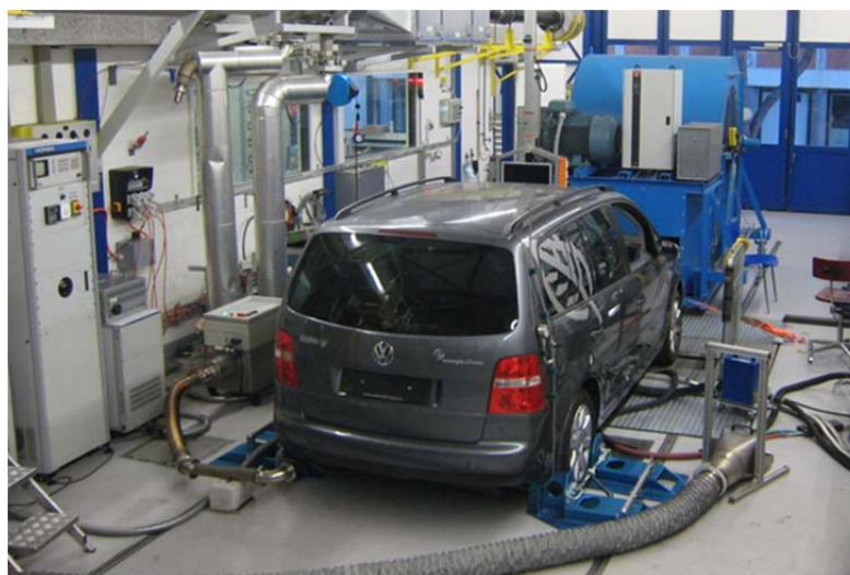
Abb. 1 Projektfahrzeug auf Rollenprüfstand
