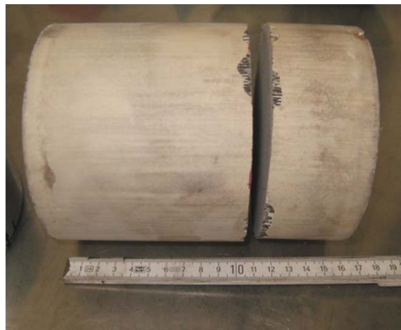
Abb. 2 Einkürzter Katalysator - nur das linke Katalysatorteil wurde verwendet.
