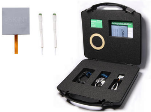
Abbildung 2: gSKIN Mess-Kit Koffer; links: Wärmeflussensor und zwei Temperaturfühler
