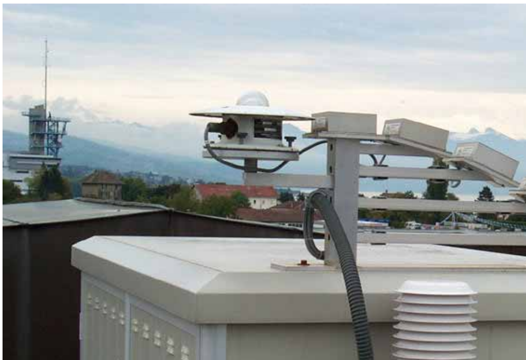
Figure 10 : vue de la station météorologique (un pyranomètre et une cellule de référence mesurent l'irradiance globale horizontale, quatre autres cellules de référence mesurent l'irradiance pour des inclinaisons de 13°, resp. 21°, 24° et 30°, correspondant à l'inclinaison de la plupart des stands).
