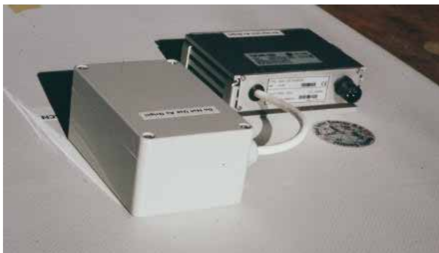
Figure 69: l'installation électrique est réduite au strict minimum grâce à l'équipement des modules en mini-onduleurs.
