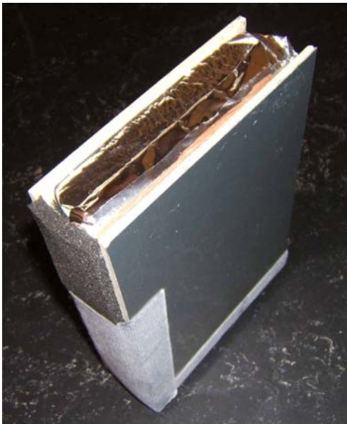
Fig. 1 QASA-Element (Fa. Variotec ) mit VIP-Kern, Beplankung und umlaufendem Randverbund (Kompri- und Klebeband).
