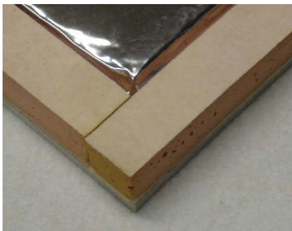
Fig. 1: Konstruktionsaufbau des mechanischen VIP-Schutzes: 4 mm Entkoppelungsplatte aus Polyesterfasern, hier nur unterseitig, 2 cm Randstreifen aus Phenolharz. Bildquelle: neofas AG
