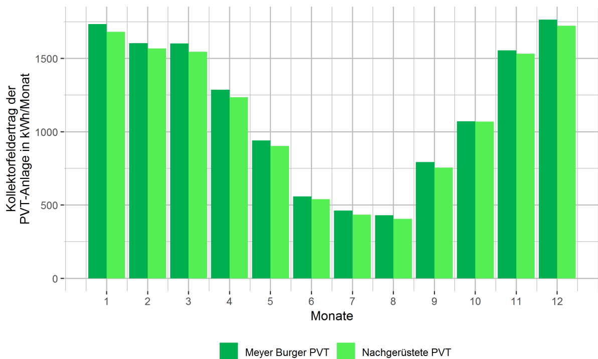
Abbildung 79: Kollektorfeldertrag im Vergleich für originale und nachgerüstete PVT-Module. Der Ertrag unterscheidet sich nur wenig.
