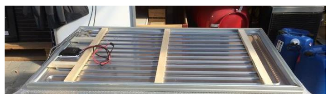
Abbildung 46: Mit Holzlatten auf die Modulrückseite geklemmter Wärmetauscher. Beispielbild mit Wärmetauscher von Meyer Burger.
