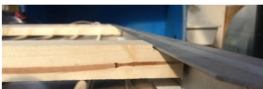
Abbildung 46: Mit Holzlatten auf die Modulrückseite geklemmter Wärmetauscher. Beispielbild mit Wärmetauscher von Meyer Burger.
