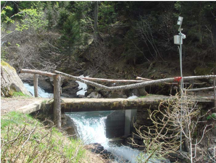
foto 7 – sistema di misurazione della portata in Meiarina 1'630 m.s.m.
