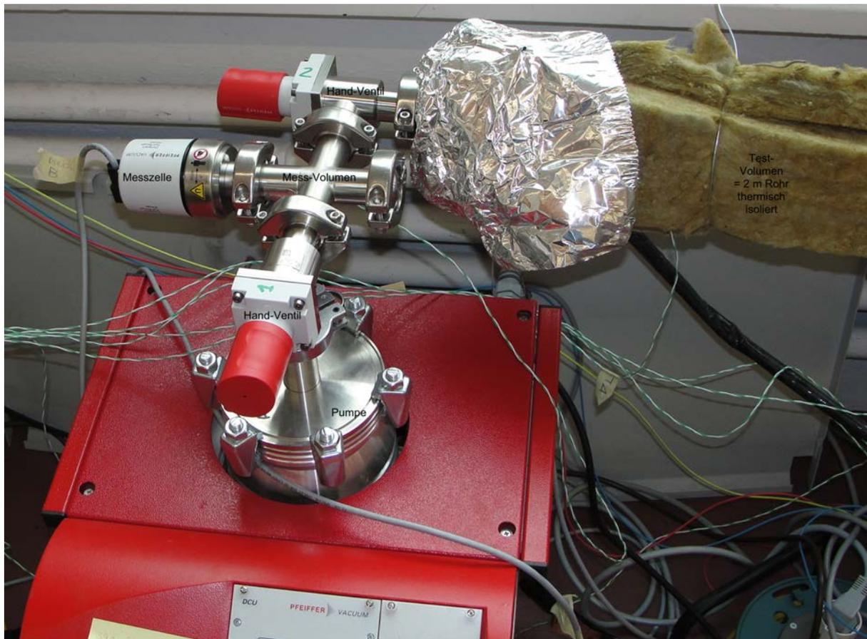
Fig. 11 Foto Messaufbau "Ausgasen Rohr"
