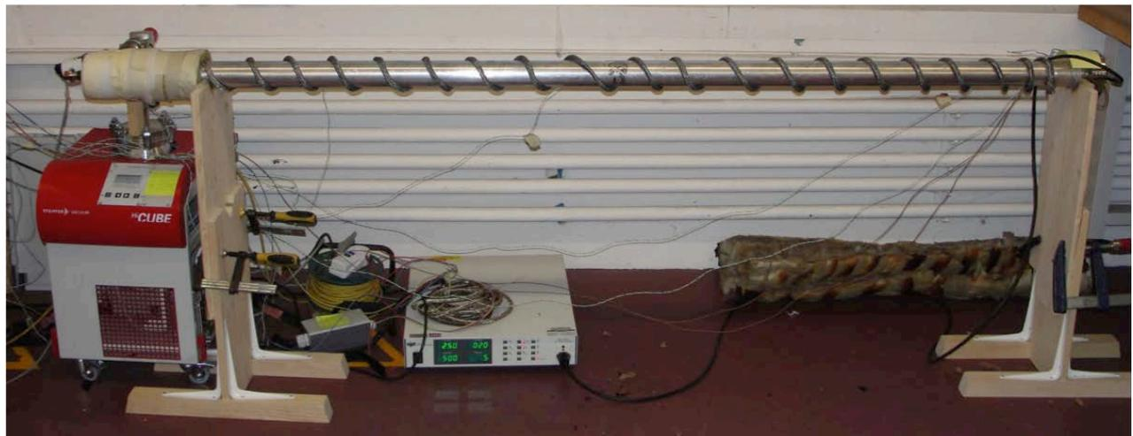
Fig. 30 Aufbau zur Messung des Wärmedurchgangskoeffizienten eines VSI-Rohres
