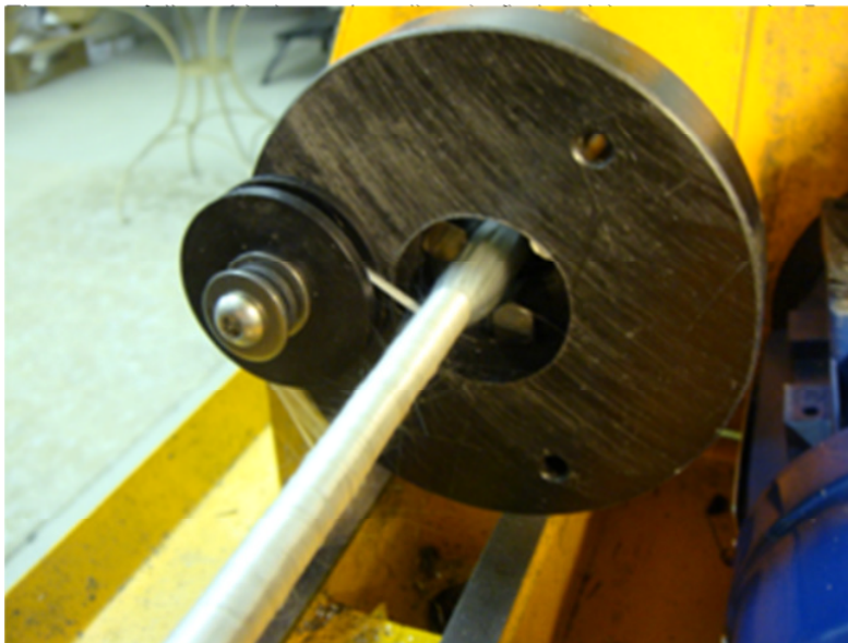
Fig. 7 Vorversuchs-Aufbau zur Umwindung von Parallel-Filament Distanzhaltern
