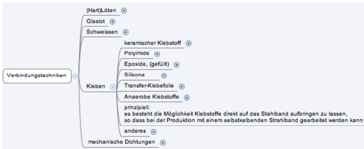
Fig. 14 mögliche Verbindungsverfahren Randband-Grenzrand
