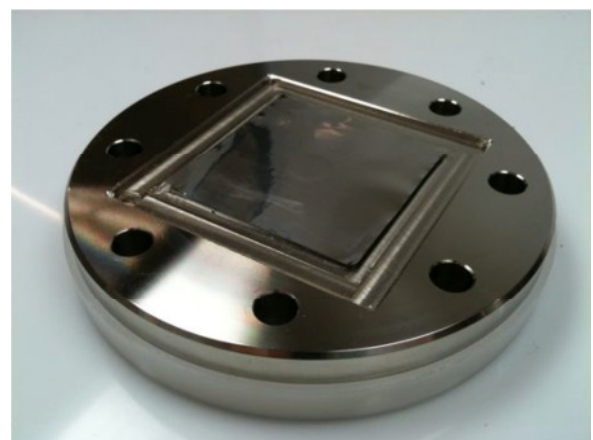
Fig. 18 CF63-Flansch mit Durchgangsloch im Zentrum und aufgeklebtem Stahlband
