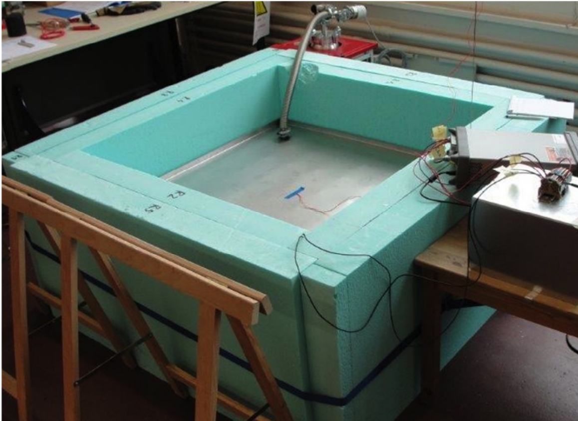
Fig. 28 Messaufbau mit VSI-Testpanel
