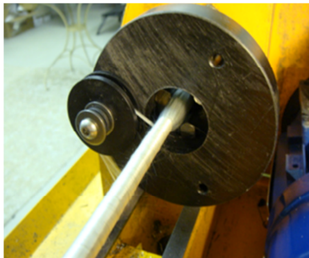
Fig. 10 Versuchs-Aufbau zur Umwindung von Parallel-Filament Distanzhaltern
