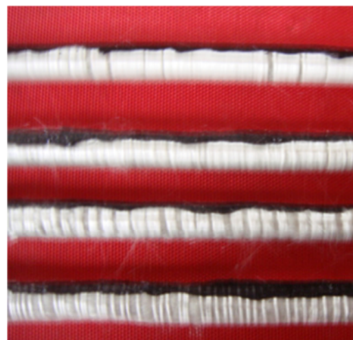
Fig. 11 PFD-Stränge mit unterschiedlichen Umwindungen
