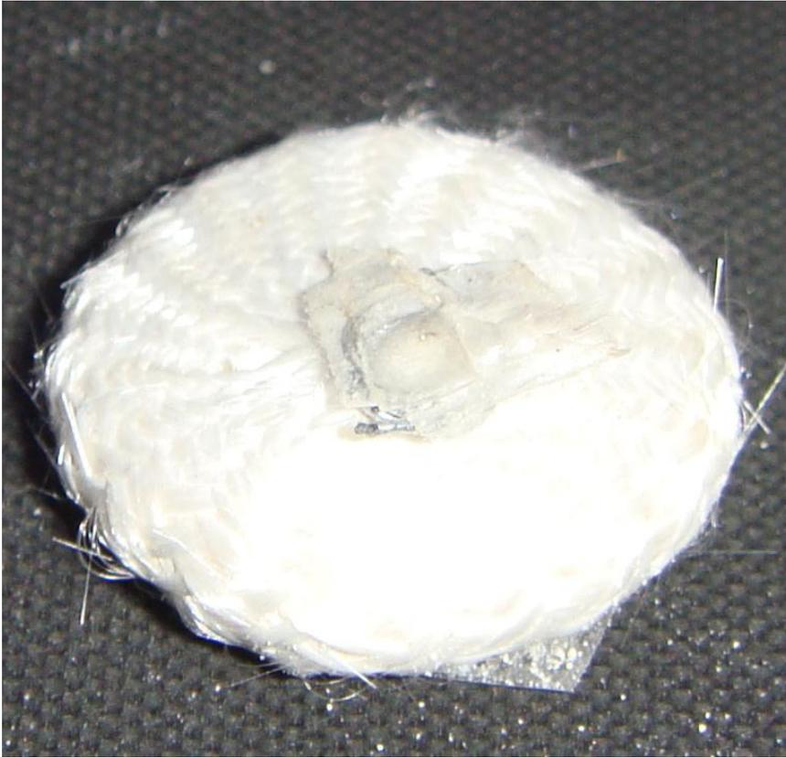
Bild 2: Ball-Distanzhalter nach einer Druck-Belastung von über 8500 N
