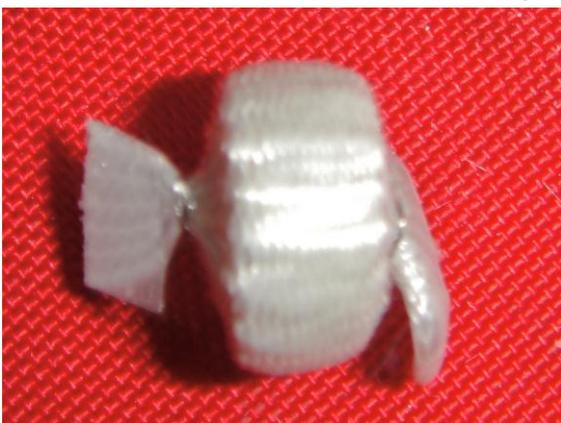
Fig. 4 von Hand hergestellter Distanzhalter nach dem Ball-Prinzip
