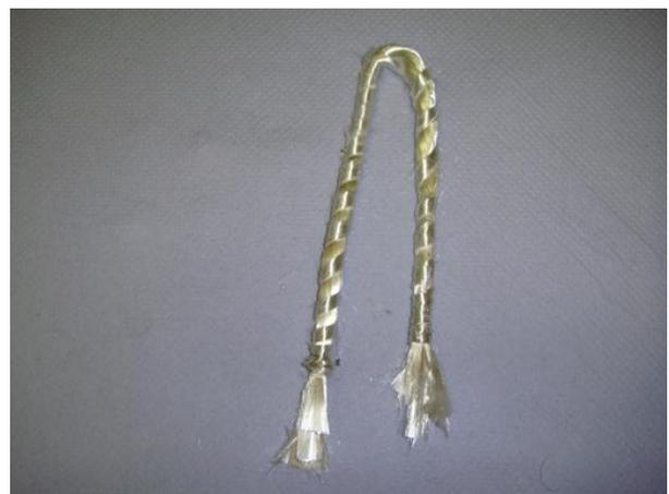
Probe nach Parallel-Filament-Prinzip
