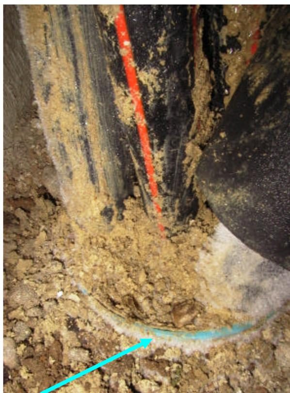
01.03.01 11:42 Abkühlung  $-10^{\circ}\text{C}$ , Ein- und Austritt mit Eiskristallen. Injektionsmasse wird leicht nach oben gepresst. Druck am Sondenfuß  $> 23$  bar ( $P_{\text{max}}$  Aufnehmer). Bei 35 m 8 bar.
