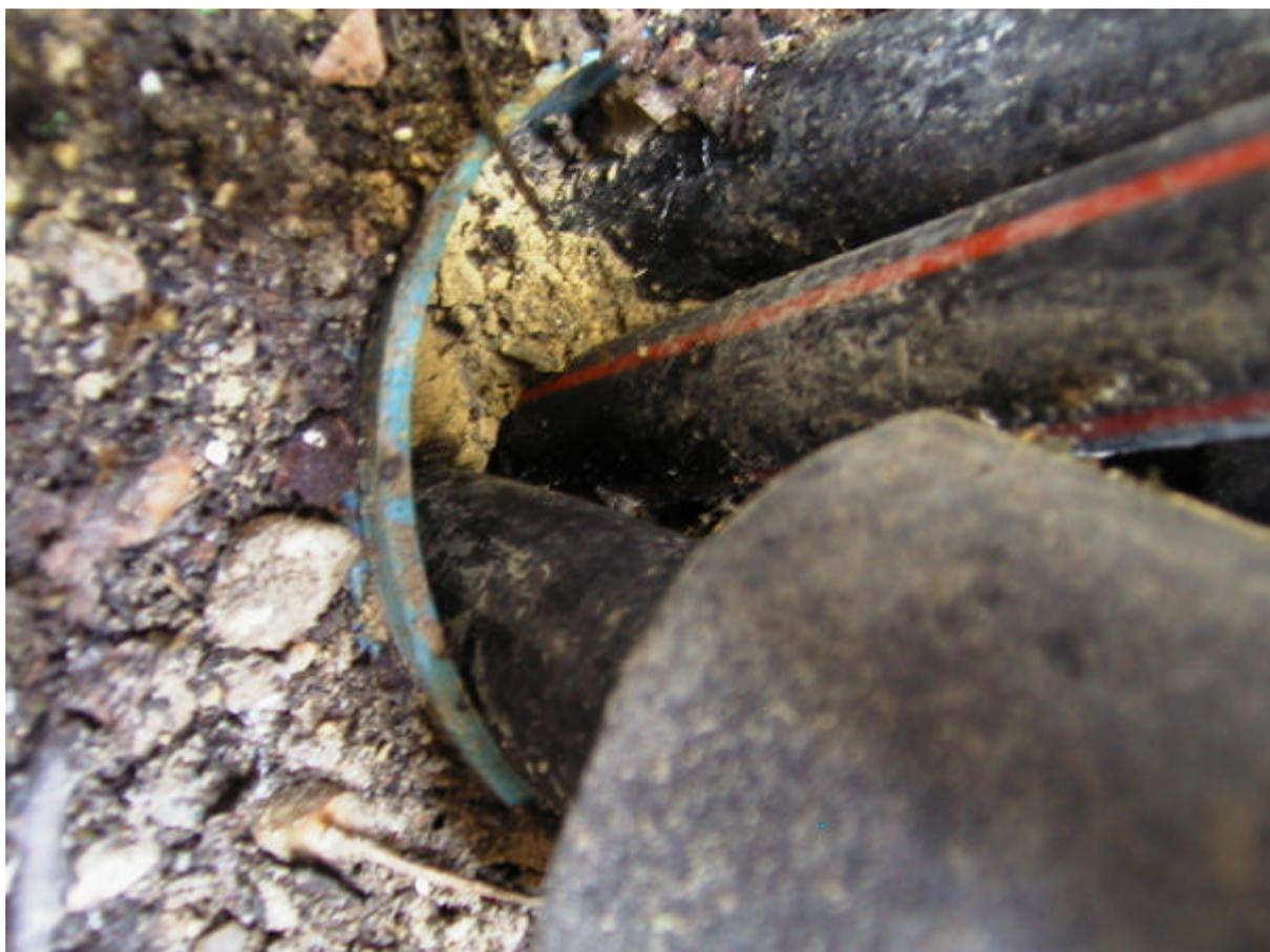
*Abbildung 23 nur geringes Nachsacken der Injektion nach den Gefrier- Tau Zyklen (28.07.01 16:07)*
