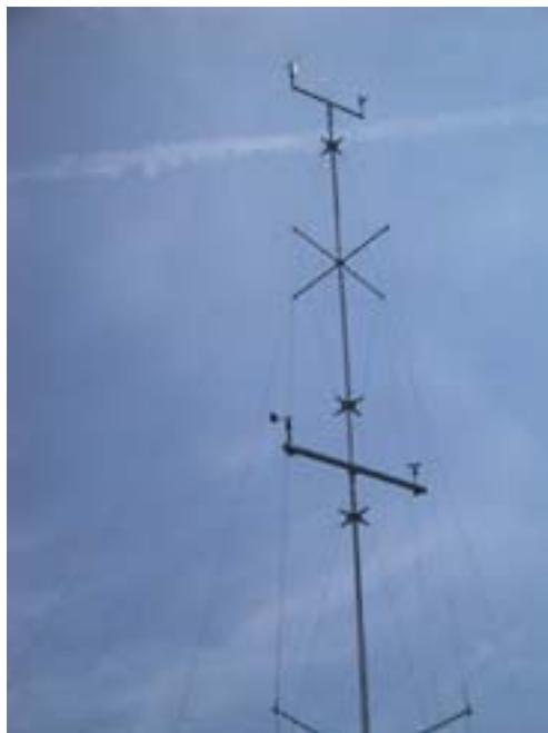
**Abb. 2** : Aventa Windmessmast bei Brütten, Konstruktion und Messanordnung (Links: schematisch, Rechts: Photo - Sensoren auf 12 und 18 m über dem Boden. Oben links Ultraschallanemometer, - Windfahne, rechts : Schalenkreuzanemometer . Unten links : Klassische Windfahne, Unten Rechts : Schalenkreuzanemometer)
