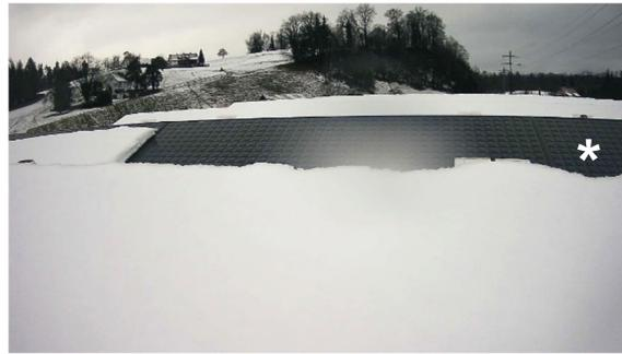
*Abbildung 29: Schneebedeckung der Kollektorreihen am 8.1.2019 (15 Uhr). Nur der Schnee auf einem Teil der rückseitig ungedämmten Kollektoren (\*) konnte abrutschen.*
