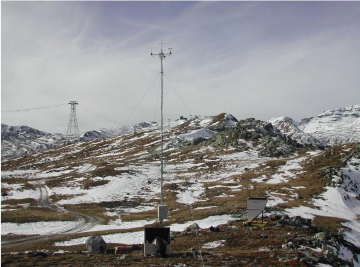
Bild 4.2: Windmessung auf Crap Sogn Gion mit Messmast 10 Meter und SODAR (im Hintergrund Bergstation Crap Masegn)
