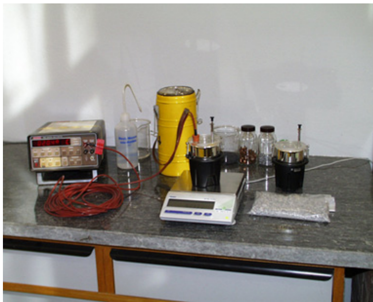
Figur 4: Verwendeter Messaufbau zur kalorimetrischen Bestimmung der Wärmekapazität von Gesteinsgranulat: Kalorimeter, Eisbäder, Waage, Präzisionsthermometer und Granulate verschiedener Materialien für Testmessungen.
