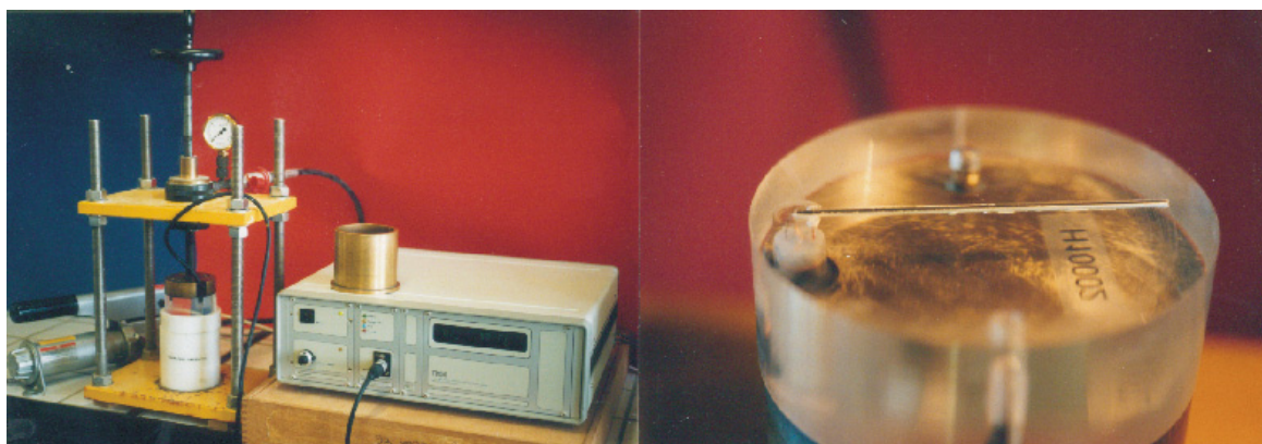
Figur 3: Apparatur zur Messung der thermischen Wärmeleitfähigkeit der Gesteine. Links: Messgerät Tk04. Rechts: Heizdraht (Länge 7 mm) in Plexiglasträger.
