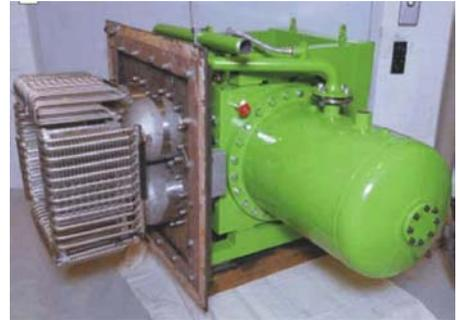
Bild: 35 kWe Stirling-Motor für Biomasse-Kessel (MAWERA/BIOS/TU Danmark)
