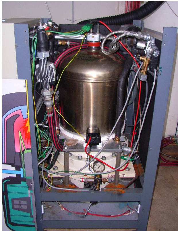
Abbildung 35: Prototyp eines Stirlingmotors der Firma AW-TEC mit einer elektrischen Leistung von 1\text{kW}
