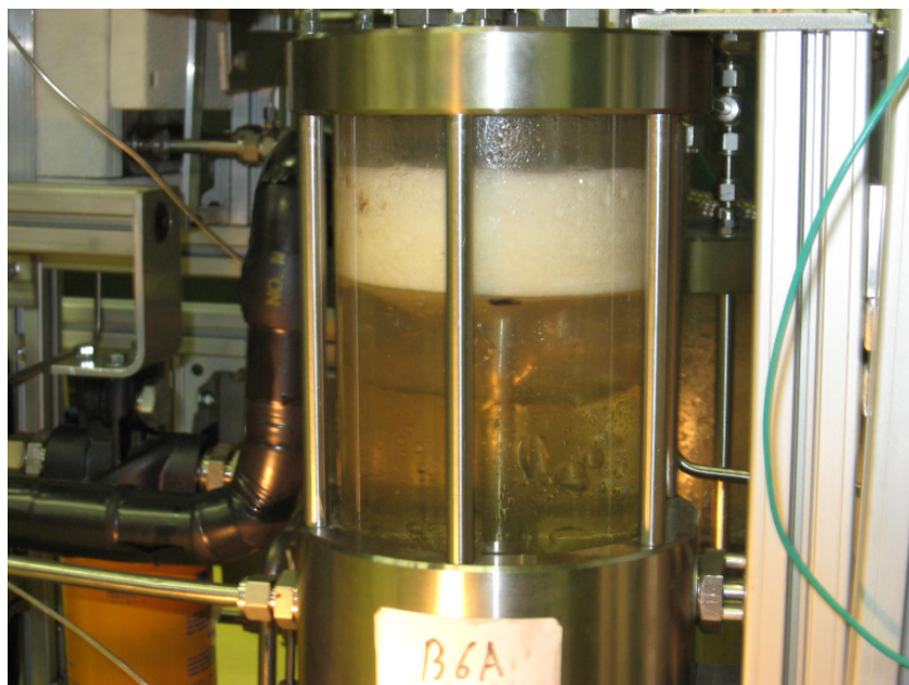
Figure 7 : Réservoir d'huile avec couches d'huile d'eau et d'émulsion d'eau en surface
