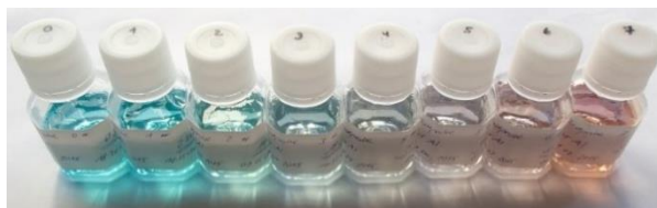
Abb. 11: Foto der Fluidproben 0 bis 7. Eine Farbänderung ist deutlich sichtbar. Die Probe 0 als Referenzprobe ist direkt aus Transportbehälter entnommen (Anzahl Stagnationen siehe Abb. 13).
