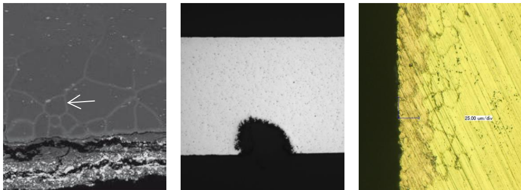
Abb. 3: Schliffbilder an einem Aluminium Absorberrohr. An den Korngrenzen diffundiert Zink in das Aluminium hinein (links). Lochfrass auf der Fluidseite an einem Absorberrohr (Rohrwandstärke 1 mm) (Mitte). Schliffbild einer Messing Stützhülse, die am Austritt des Mäanderabsorbers montiert war und dabei die überwiegende Zeit einer Temperatur von T=200\text{ °C} ausgesetzt war. Im Bild ist eine Entzinkung des Messings bis einer Tiefe von 40\mu\text{m} sowie Entzinkung an den Korngrenzen sichtbar. Die Stützhülse hatte eine Fluidexposition von ca. 1150 h (48 Tage) (rechts).
