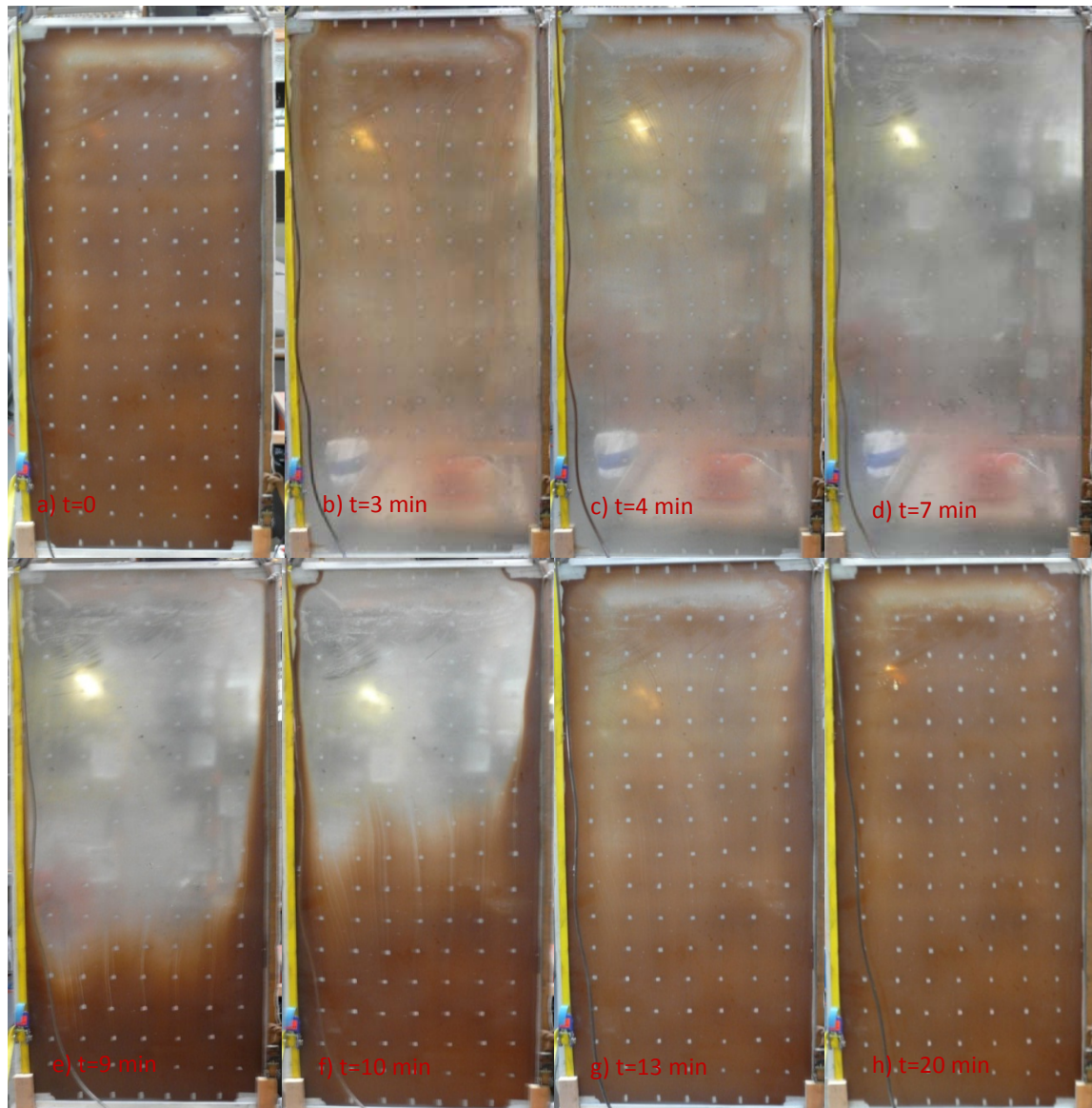
Abbildung 42: (a-d) Bilder des Kollektors während des Filterprozesses. Der Kollektor wird von unten nach oben durchströmt. (e-h) Bilder des Kollektors während dem Durchspülen des Filters.
