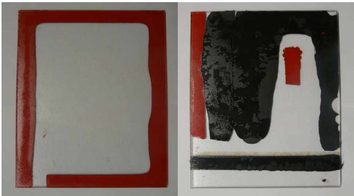
Abbildung 6: Solarglasmuster mit aufvulkanisierten EPDM-Mustern variabler Zusammensetzung Im A4-Format
