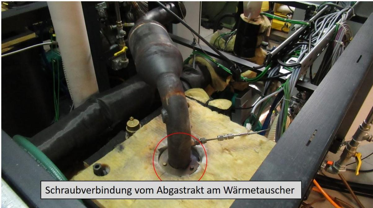
Abb. 17: Übergang vom Abgastrakt in den Wärmetauscher
