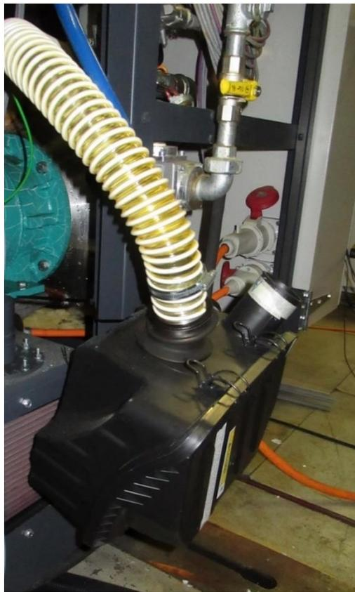
Abb. 22: Serien-Luftfilterkasten vom Motor auf PT4 installiert.
