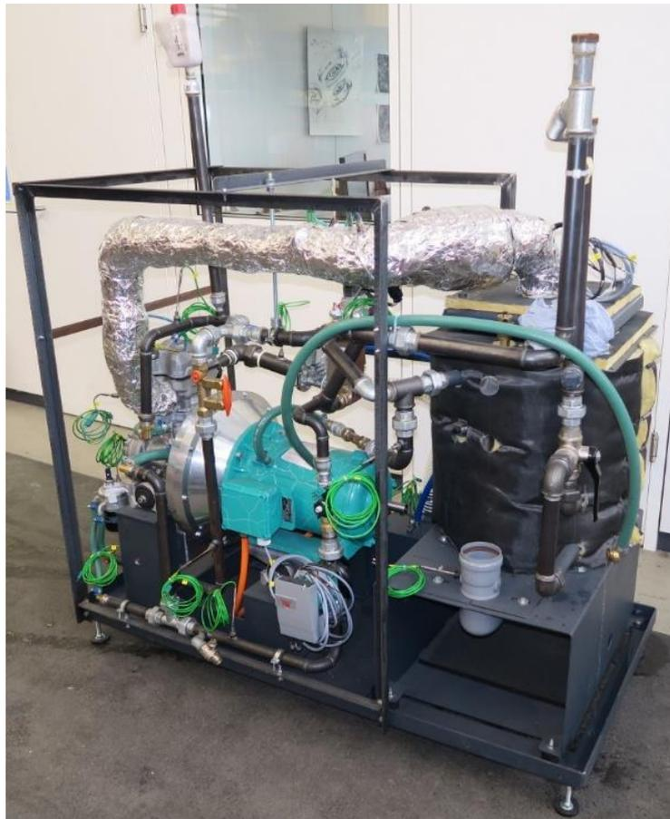
Abb. 5: PT5 in der Zwischenversion Dezember 2016 mit vorläufigem Rahmen, Hydraulik und Wärmedämmung Abgastrakt. Der Schaltschrank ist auf einem gesonderten Rahmen montiert worden.
