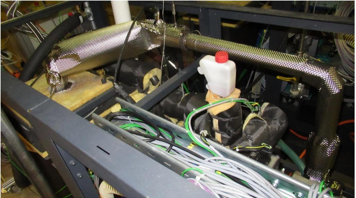
Abb. 20: Abgastrakt in Hitzeschutzblech eingewickelt.
