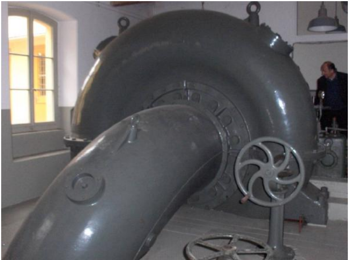
Bild 12: Bestehende Francis-Turbine 1 von Escher-Wyss mit H_n=7.5\text{m} und Q=3.0\text{m}^3/\text{s}
